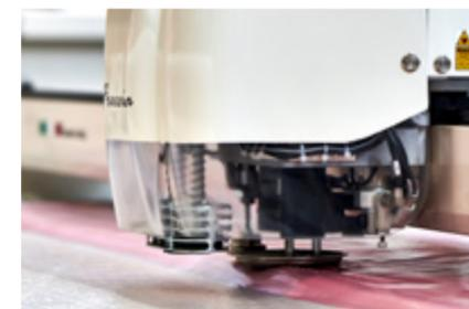
Dispositivo de perforación individual o doble con control de temperatura.
